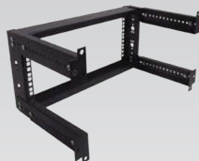
RKB04-345 (Abierto Ajustable 4U): UH= 24,5; UW= 48; UDmax= 38 UDmin= 23 PH= 24,5; PW= 50,5; PDmax= 45,5 PDmin= 30,5 EH= 31,5; EW= 51,5; ED= 22,5 Peso con empaque: 6,5 kg.
